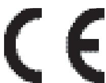
En France, le marquage CE est obligatoire pour tous les granulats commercialisés pour des usages de bétons et mortiers. Le marquage CE garantit la traçabilité du granulat et sa conformité aux normes EN 13139 (mortiers) et EN 12620+A1 (béton), qui est notamment requise pour réaliser des bétons conformes à la norme EN 206. Le niveau CE2+ garantit la certification par un organisme de contrôle indépendant.
